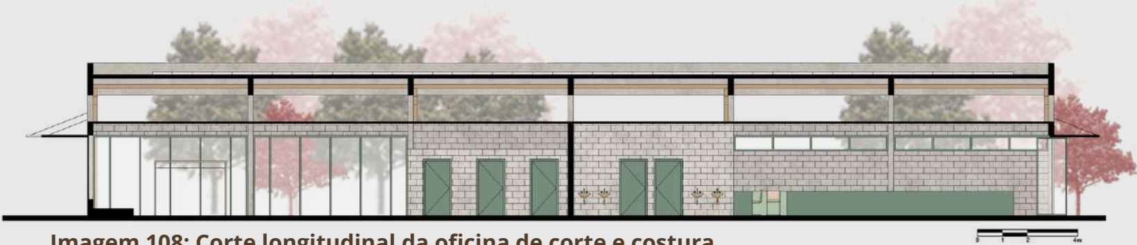
Imagem 108: Corte longitudinal da oficina de corte e costura
