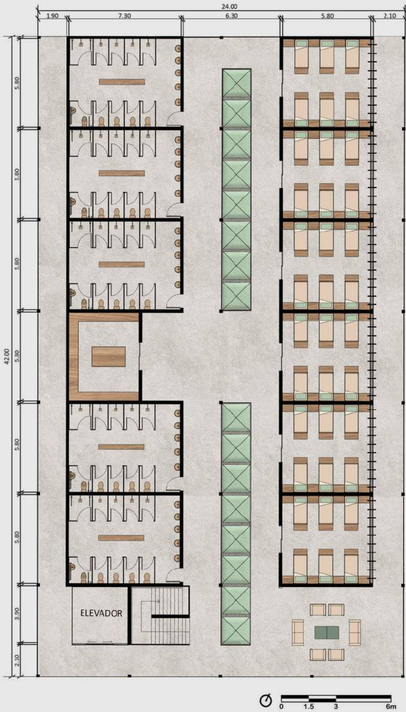
Imagem 61: Planta baixa do pavimento superior do dormitório masculino
