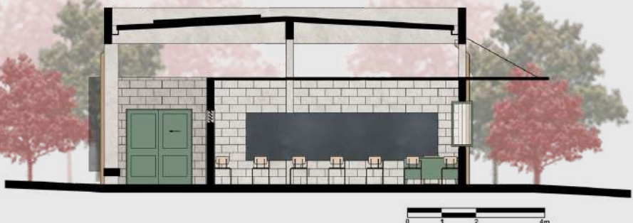
Imagem 80: Corte transversal do bloco de salas de aula
