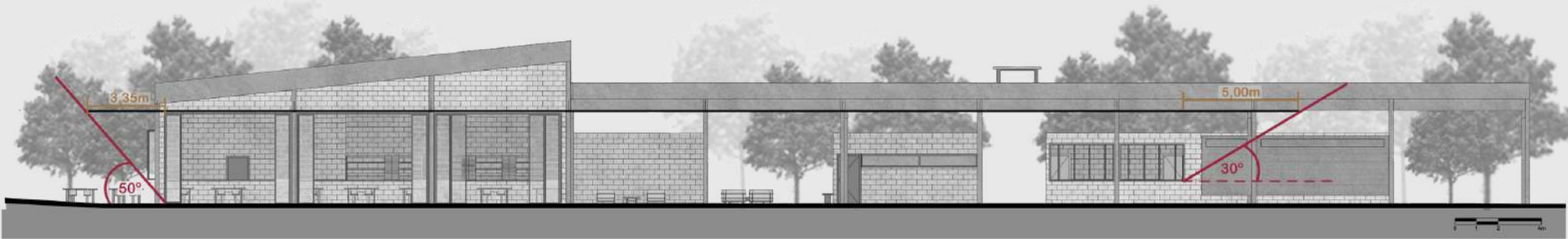
Imagem 48: Demonstração do dimensionamento do brise horizontal da fachada noroeste do edifício de serviço (ângulo gama)
