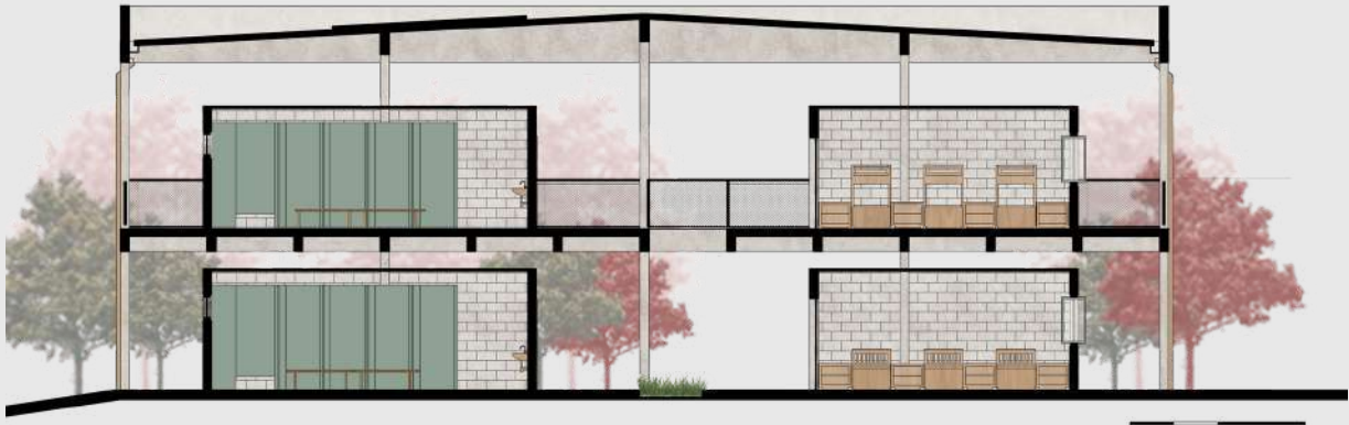
Imagem 68: Corte transversal dos dormitórios
