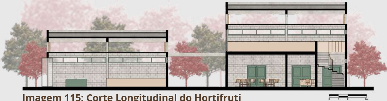
Imagem 115: Corte Longitudinal do Hortifruti
